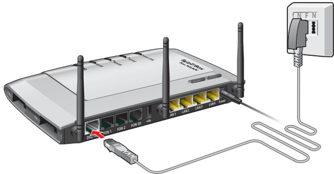
Anschluss mit DSL-Kabel
