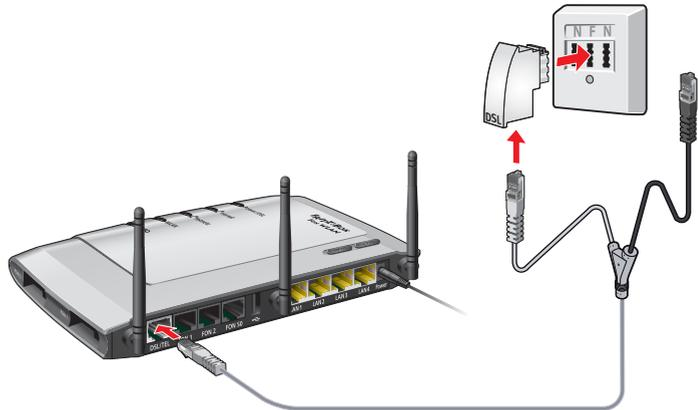
Anschluss mit DSL-/Telefonkabel und DSL-Adapter
