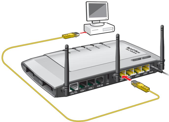
Anschluss eines Computers mit einem Netzwerkkabel
