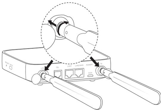
③ Schrauben Sie die externe Antenne vollständig an den Antennenanschluss.
