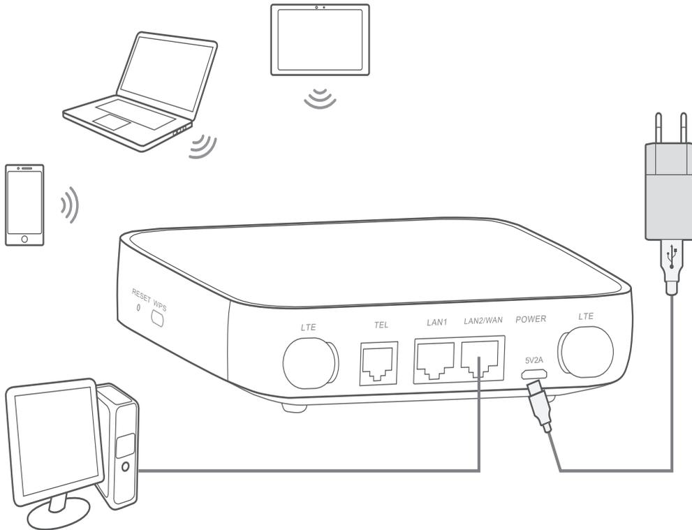
Um Interferenzen durch Funksignale zu verhindern, halten Sie bei der Montage des Cat4-Routers mindestens 1 Meter Abstand zu Telefonen und anderen elektrischen Geräten.
