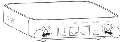
② Öffnen Sie an beiden Seiten die Abdeckungen der LTE-Antennen-Anschlüsse.
